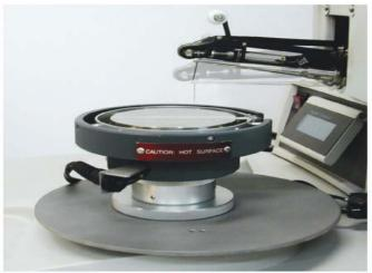
K&S 4523XAD1型深腔楔焊机,功能多样,具有万能生产能力,可创造出业界的最佳价值,支持混合电路,MCM多芯片模块、光学器件、微波器件、激光器件及分立器件等多种楔形焊接应用。
