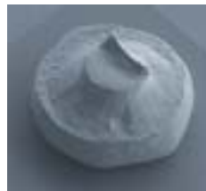
利用 AccuBump 功能修剪植球尾部，可確保植球平面度達 \pm 2.5 \mu\text{m} 。
